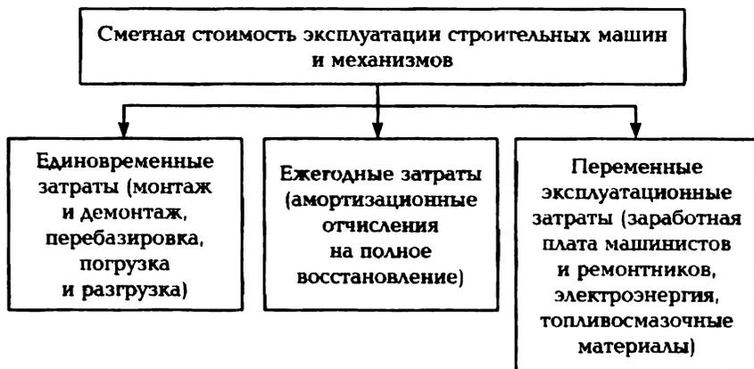
**Рис. 2.1.** Структура затрат, определяющих сметную стоимость эксплуатации строительных машин и механизмов
